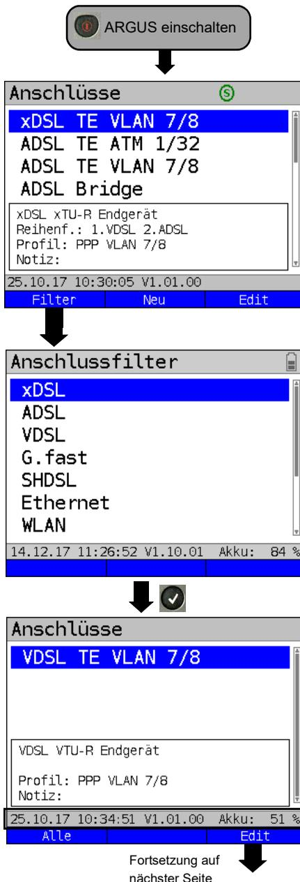
Der ARGUS zeigt nach dem Einschalten alle konfigurierten Anschlüsse (bis zu 100 Stück) an. Defaultmäßig sind die häufigsten in Deutschland vorkommenden Anschlüsse vorkonfiguriert.
