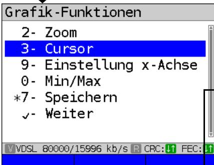
Die Cursor-Funktion dient zum genauen Ausmessen der Graphen.
