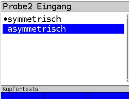
Nachdem ein Test gestartet und die Active Probe II aktiviert wurde, lässt sich mit der Zifferntaste **8** der Probe-Eingang zwischen symmetrisch und asymmetrisch umschalten.
