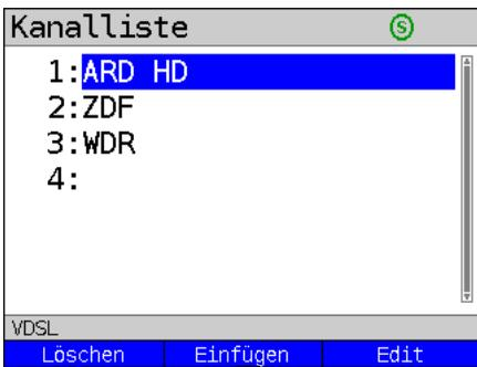
Der ARGUS zeigt zunächst die bereits ausgewählten TV-Kanäle in der eingestellten Reihenfolge an, die beim IPTV-Scan getestet werden. Wurden noch keine Kanäle ausgewählt, ist die Liste zunächst leer.
